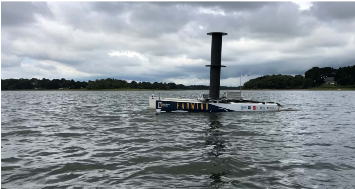
Figure 1 : Photo du prototype de navire énergie testé en 2021 et propulsé par un rotor Flettner
